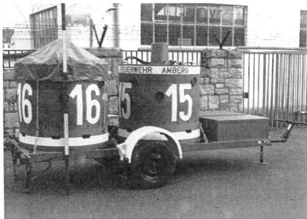
Zu einem Satz gehören je 2 Löschwasser-Außenlastbehälter SMOKEY III. Sie sind mit Zubehör auf einem Einachsanhänger verlastet, damit im Bedarfsfall ihr Transport ins Einsatzgebiet – ggf. auch über größere Wegstrecken – kurzfristig sichergestellt werden kann.
