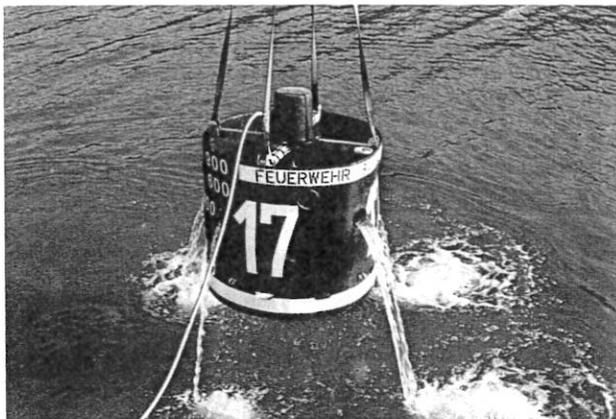
Die Steuerung ist so feinfühlig, daß – in Verbindung mit entsprechenden Flugbewegungen des Hubschraubers – das Wasser je nach Erfordernis punktförmig oder zur Flächenbenetzung an der Einsatzstelle und zur Befüllung von Zwischenbehältern abgelassen werden kann.
