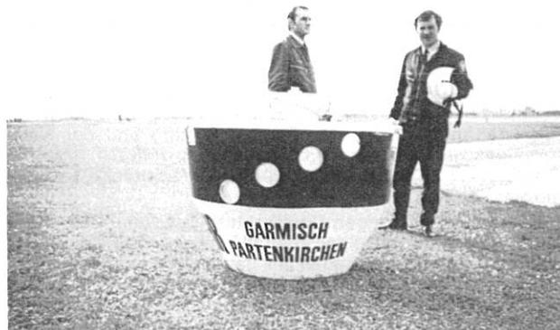
Mit 12 Überlauföffnungen im Behältermantel, die mit Kunststoffkappen verschließbar sind, kann die Füllmenge auf 420 l, 340 l, 265 l und 190 l begrenzt werden.
